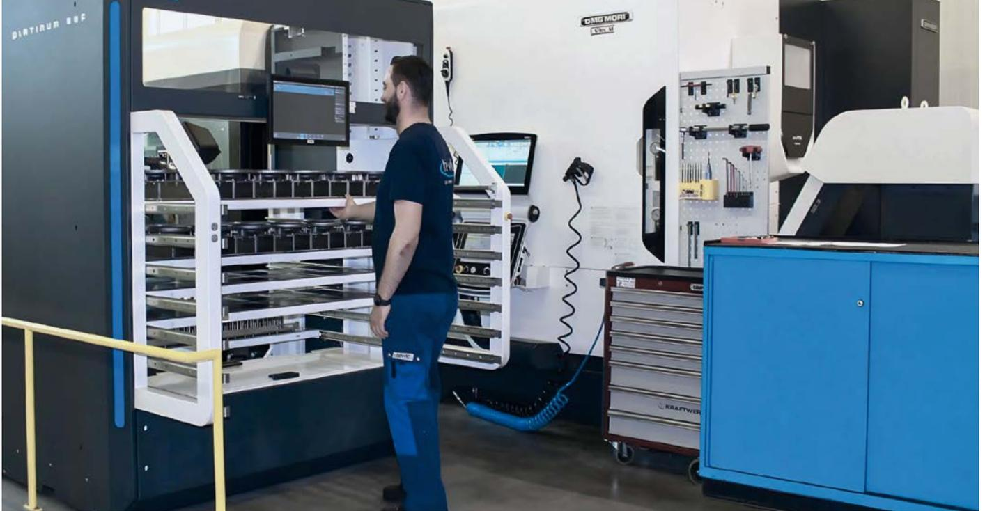
Komplexe Ventildeckel aus GGG40 auf einer DMG Mori NTX2500 in Kombination mit dem BMO Platinum 88 Frontloader (Roboterlösung)
